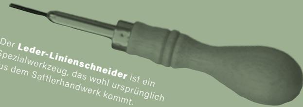
Der **Leder-Linienschneider** ist ein Spezialwerkzeug, das wohl ursprünglich aus dem Sattlerhandwerk kommt.
